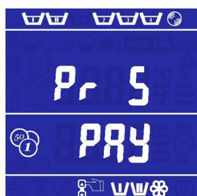
"PRY" et le numéro de programme apparaissent sur l'afficheur. Après le paiement du montant complet au panneau de commande central, "S t R" apparaît sur l'afficheur et il faut faire démarrer la machine en appuyant sur la touche marche/arrêt.
