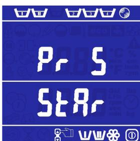
Quand le hublot est fermé, on doit de nouveau confirmer le démarrage de la machine en appuyant sur la touche marche-arrêt (D). "PRESS START" défile sur l'afficheur.
